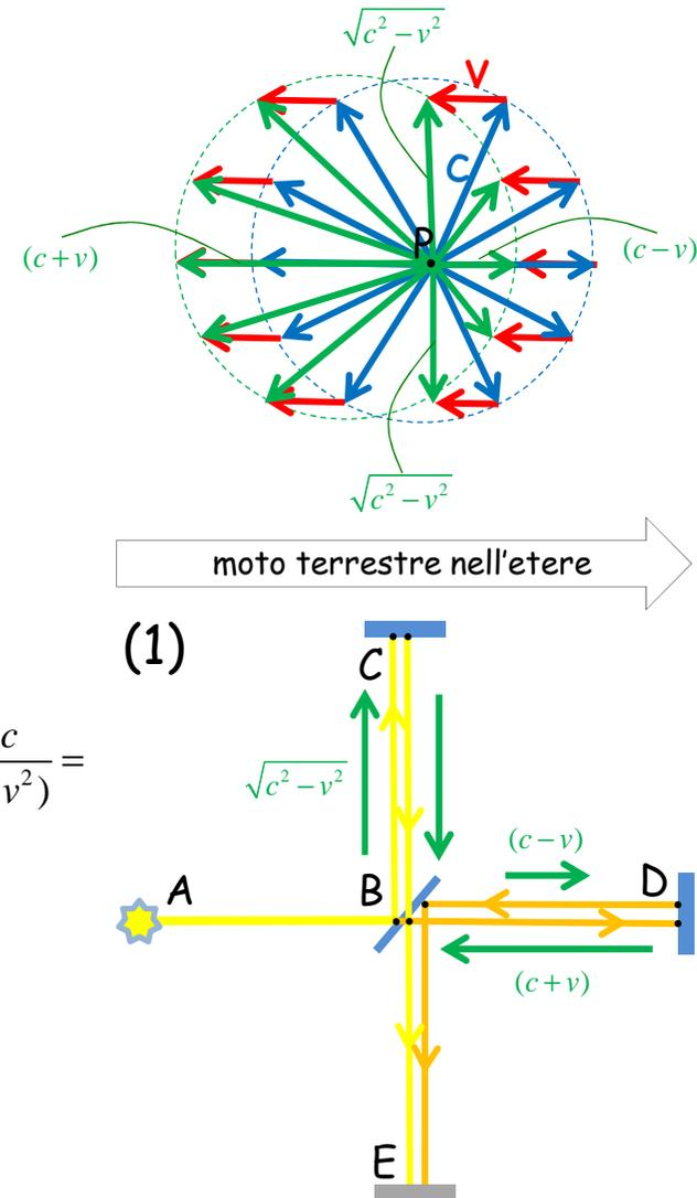
Ora ruotiamo l'interferometro nella posizione (2) con il braccio CBE lungo la direzione del moto terrestre nell'etere e calcoliamo nuovamente i tempi di percorrenza dei due raggi.
