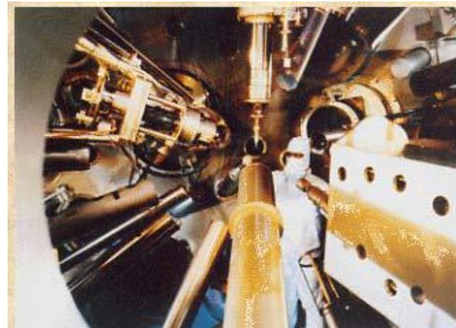
Immagine dell'esterno e dell'interno della camera di fusione o di scarica con confinamento inerziale Lawrence Livermore Laboratory USA
