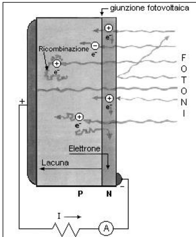
Una cella fotovoltaica è sostanzialmente un diodo di grande superficie.
