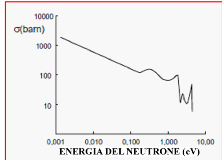
Anche se i nuclei di tutti gli elementi con elevata massa atomica possono essere scissi se colpiti da un neutrone, è l'isotopo  $^{235}\text{U}$  dell'uranio a possedere un'elevata probabilità per la fissione anche se colpito da un neutrone lento (un neutrone lento rimane più a lungo nelle vicinanze del nucleo e quindi viene catturato più facilmente). Ciò vale anche per  $^{233}\text{U}$  e  $^{239}\text{Pu}$  (*isotopi artificiali*).
